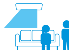
Flux d'air dirigé à l'écart des occupants
